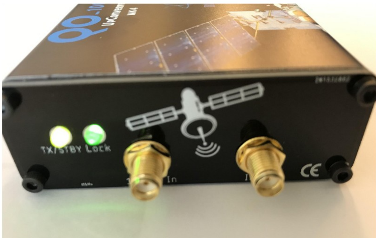
Fig3 Mode veille, LED de verrouillage verte et LED TX/STBY verte.
