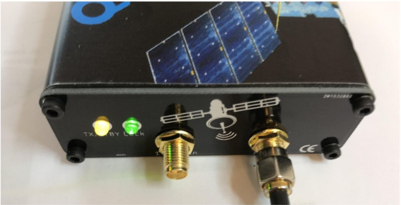
Fig 4 Mode TX, la LED TX/STBY est orange
