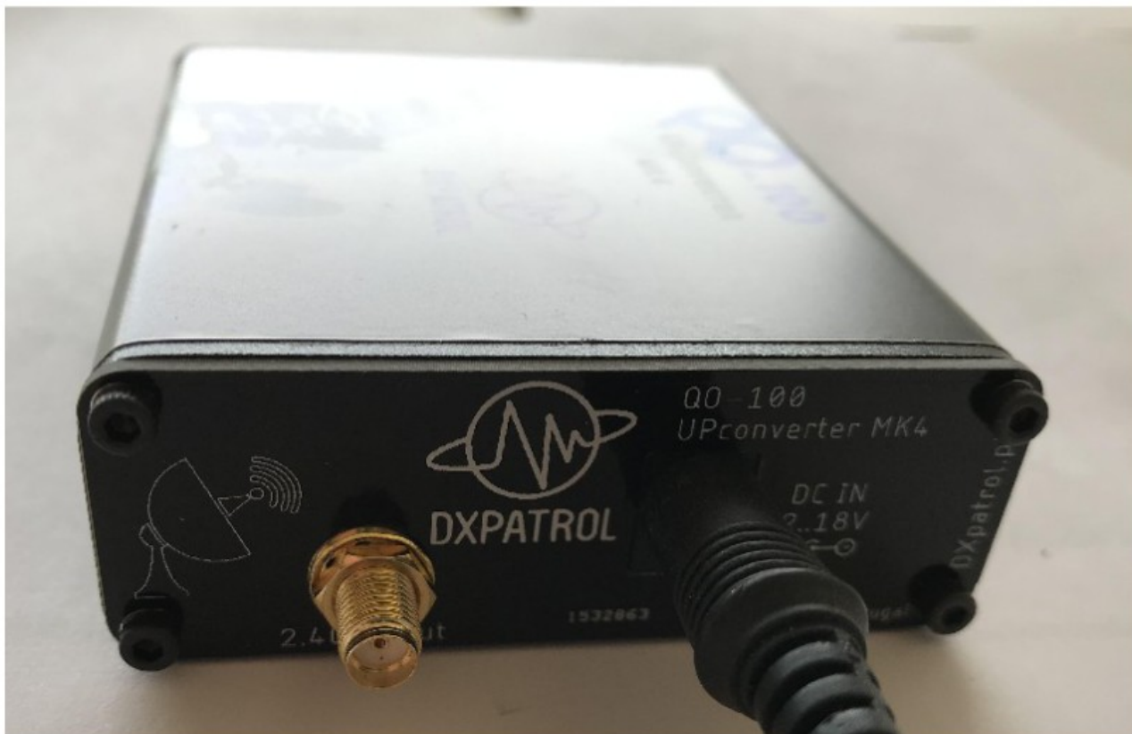
Fig 2 Connexion CC, (positif à la broche centrale)
