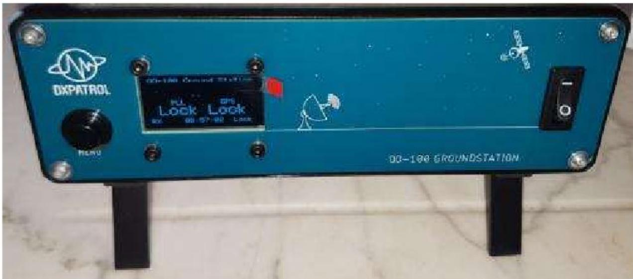
La Ground Station dispose de 2 pieds inclinables en bas, sur le côté avant, pour un accès et une utilisation faciles. À gauche le bouton menu, l'écran OLED suivant et à droite l'interrupteur ON/OFF.
