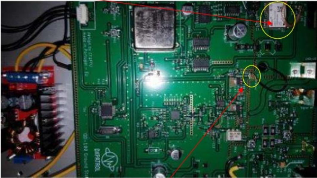
Sortie du convertisseur vers l'amplificateur de puissance final
