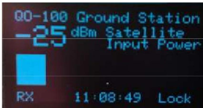
Cette page affiche la force du satellite d'entrée. Ceci est affiché en dBm et c'est très utile pour pointer la parabole et réglage fin du LNB dans le point focal.
