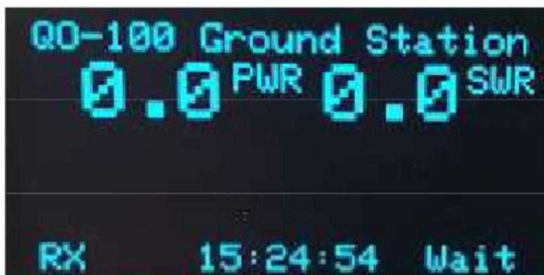
Mode RX, aucune alimentation/SWR détectée, horloge et attente.
