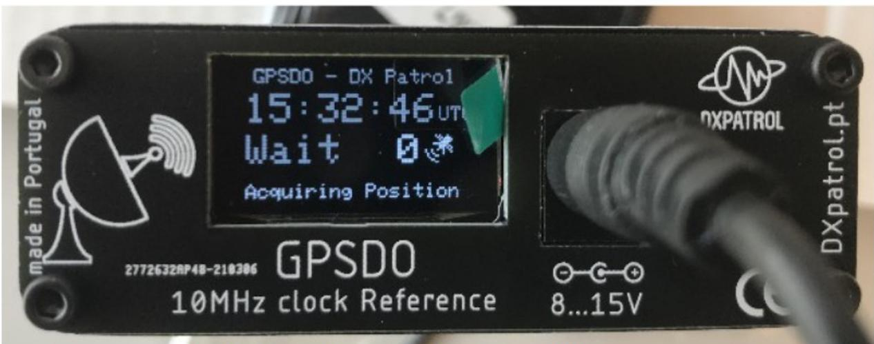
Fig 6 : horloge UTC détectée, en attente d'autres satellites.
