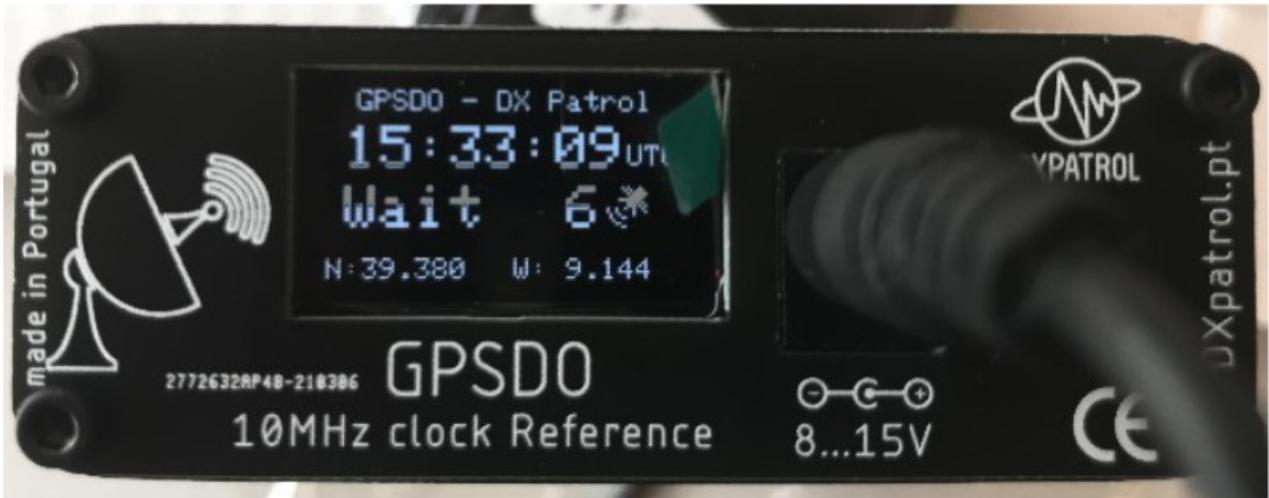
Fig 7 : 6 satellites en portée, horloge et coordonnées détectés. OCXO s'échauffe
