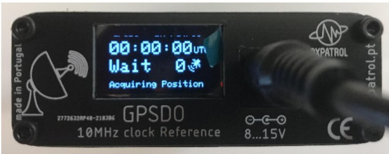
Fig 5 : démarrage ON, pas de GPS reçu ou pas d'antenne connectée.
